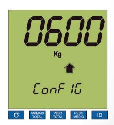
Use a tecla T/SETA DIREITA para incrementar o dígito, e a tecla V/SETA ESQUERDA para decrementar o dígito. Pressione rapidamente as teclas para incrementar ou decrementar o valor em uma unidade, ou mantenha a tecla pressionada para incrementar ou decrementar o valor mais rapidamente.
