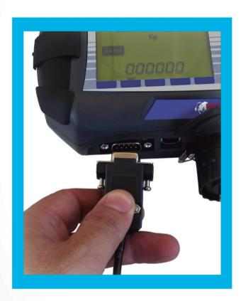
1. Conectar o cabo serial no conector do indicador.
