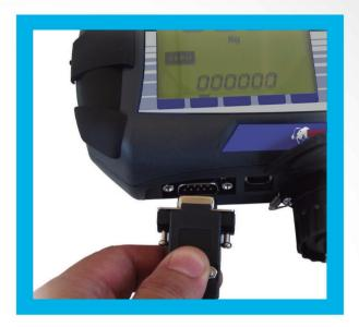
1. Conectar o cabo serial no conector do indicador.
