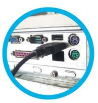
3. Conectar o adaptador serial-USB na porta USB do seu computador
