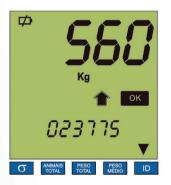
Na parte inferior da tela aparece o display auxiliar, que se refere a Função indicada pela seta. A Função mostrada no display auxiliar pode ser alterada pela tecla F-Função.
